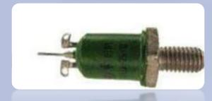
*Тринисторы применяют в регуляторах мощности, контакторах, ключевых преобразователях и инверторах.*
